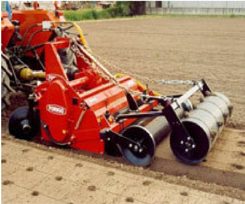
Fig. 2.42. Agregat agricol pentru modelarea și executarea de gropițe la o singură trecere
