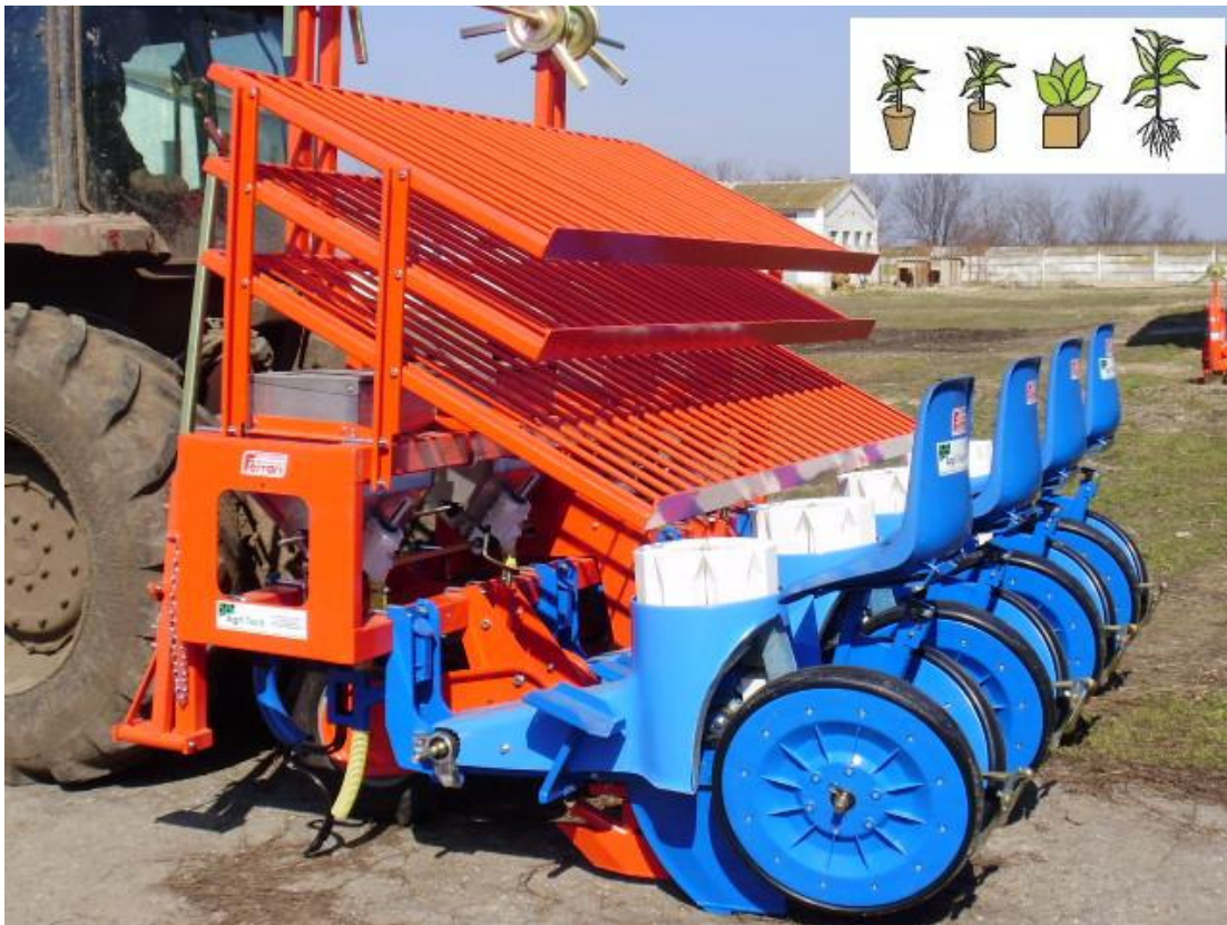
Fig. 2.47. Mașină semiautomată de plantat ghivece și cuburi nutritive
