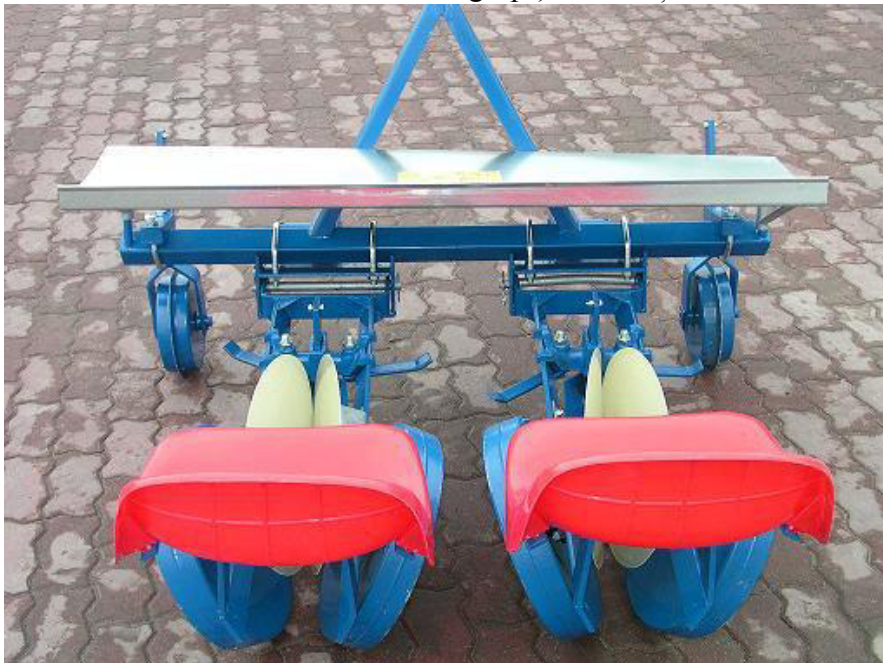
Fig. 2.43. Mașina de plantat răsaduri fără ghivece nutritive
