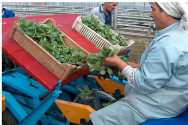
Fig. 2.44. Mașină de plantat răsaduri fără ghivece nutritive
