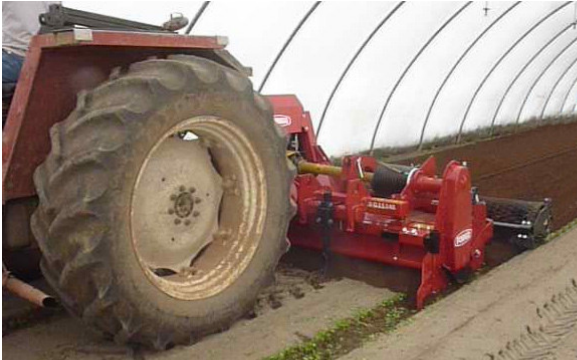
Fig. 2.32. Agregat de prelucrat solul în sere și solarii de tipul tractor-freză-tăvălug
