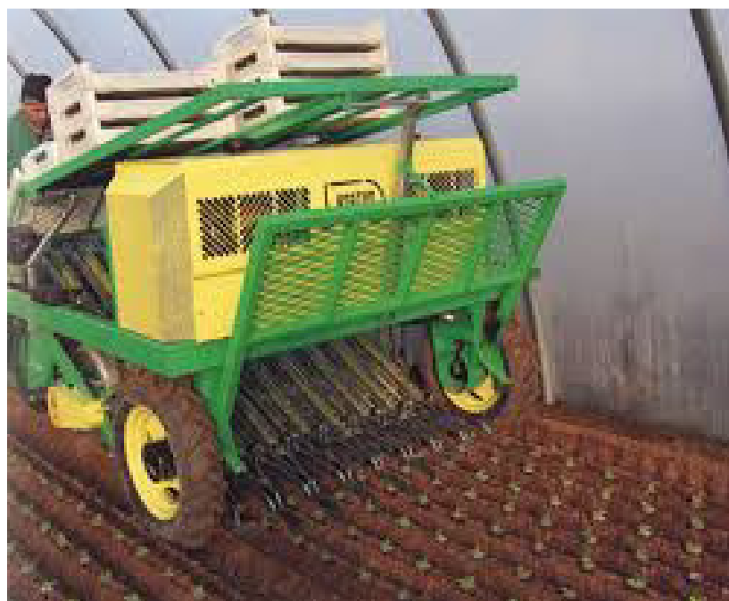
Fig. 2.44. Mașină de plantat răsaduri fără ghivece nutritive
