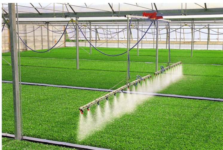
Fig. 2.53. Irigarea plantelor cu rampă mobilă
