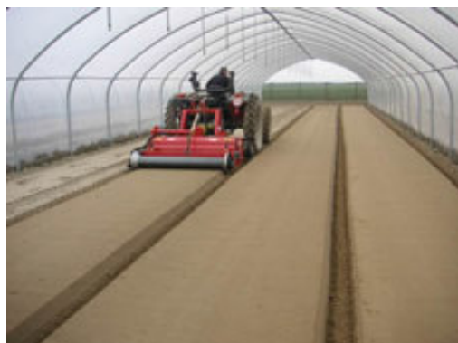
Fig. 2.39. Agregat pentru modelarea solului în benzi
