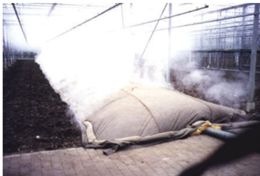
Fig. 2.34. Instalație de dezinfectie as solului cu abur si prelată
