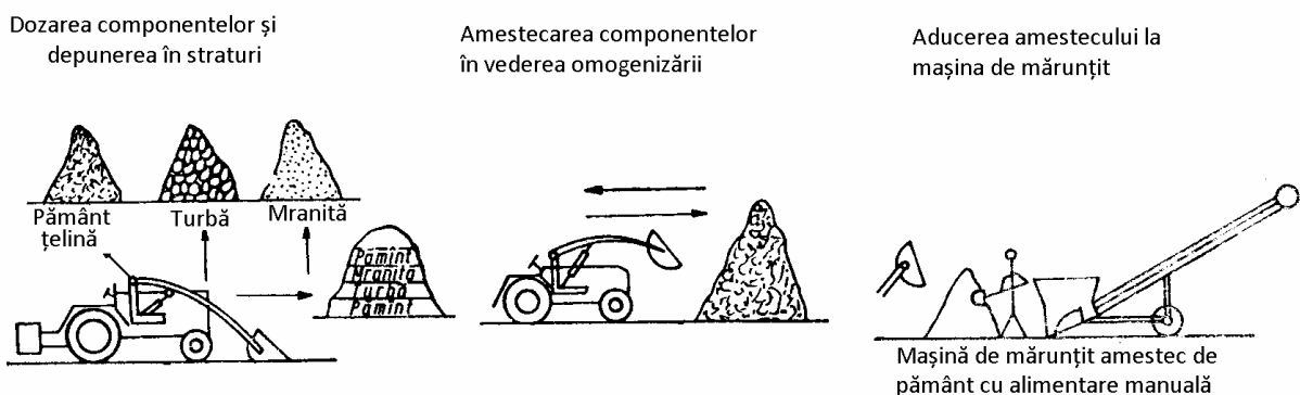
Linie tehnologică de capacitate mică pentru pregătirea amestec nutritiv
