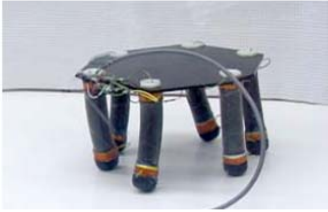
Figura 5.58 MERobot, un robot care folosește role cu arc cu 2 grade de libertate pentru fiecare din cele șase picioare (Pei și colab., 2003)
