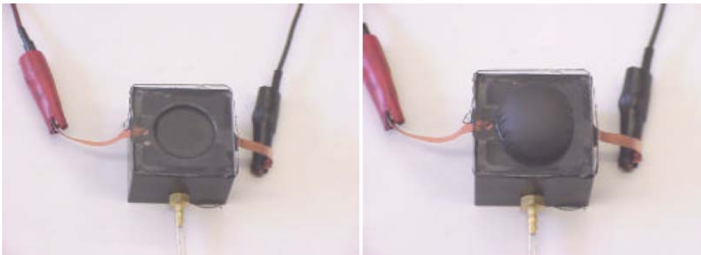
Figura 5.39 Deflexia (bombarea) unei diafragme din film acrilic (Bar-Cohen, 2004)
