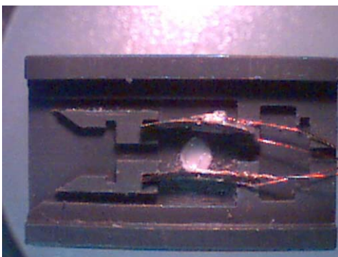
Figura 5.23 Pompă cu diafragmă dublă din IPMC
