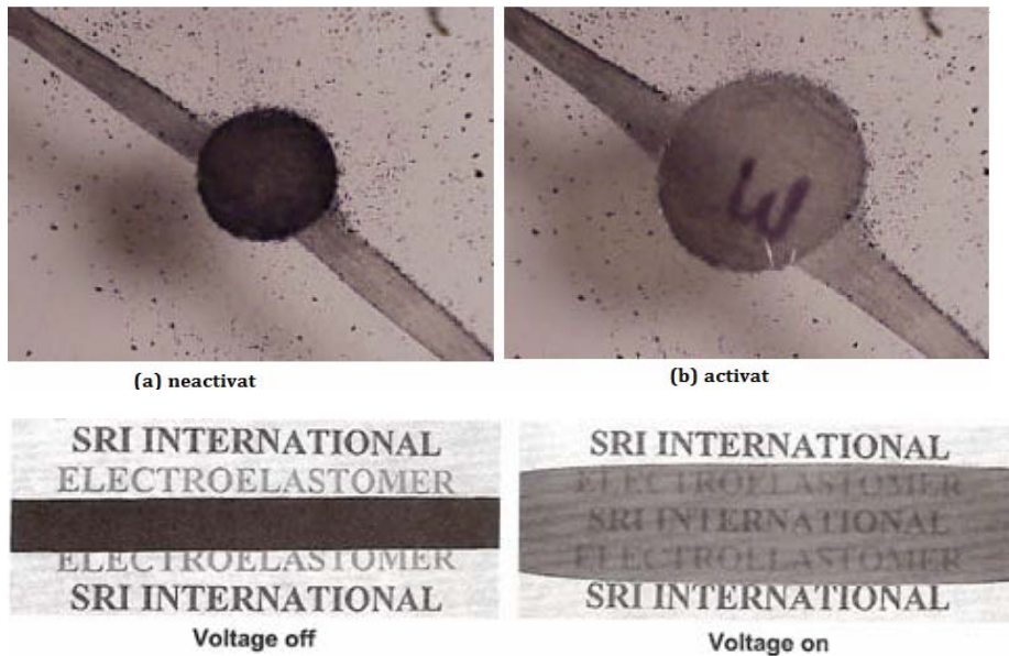
Figura 5.45 Exemple de aplicații optice cu actuatori elastomer dielectric (Kornbluh și colab., 2000; Bar-Cohen, 2004)
