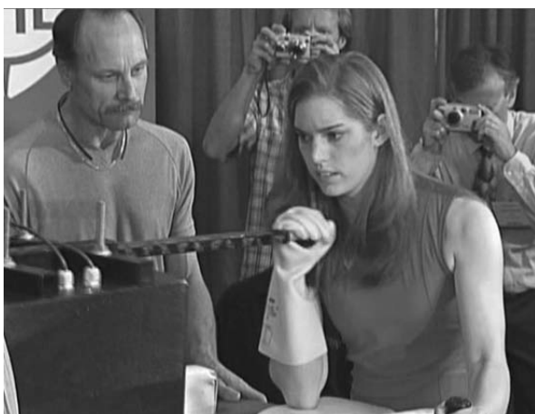
Figura 5.37 Braț realizat de EMPA. Eleva folosește o mănușă de cauciuc pentru a se proteja de circuitul electric (Bar-Cohen, 2006)
