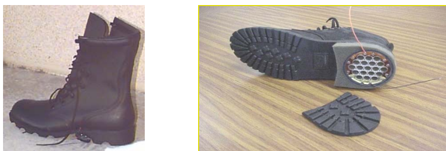
Figura 5.51 Generator pe bază de elastomeri dielectrici plasat în călcâiul unei cizme (Bar-Cohen, 2004)
