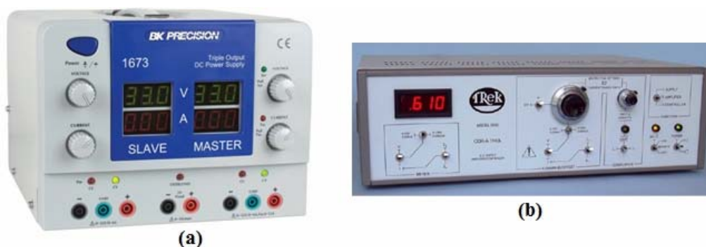
Figura 6 (a) Sursa de tensiune continuă pentru alimentare senzor și (b) sursa de înaltă tensiune pentru stimularea probelor
