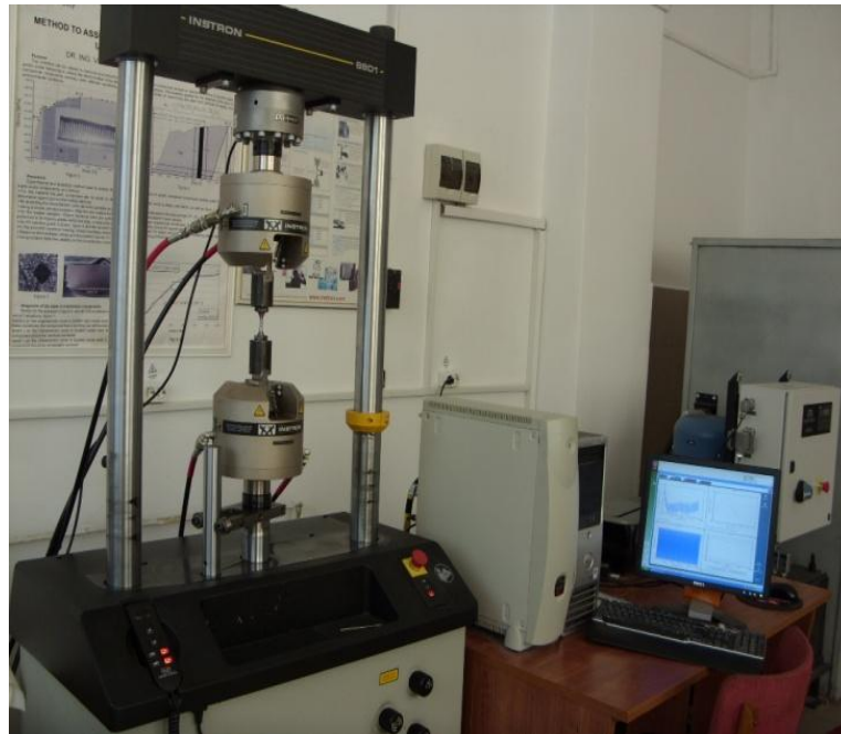
Fig. 2.3. Mașina de încercat Instron 8801 – solicitarea la oboseală
