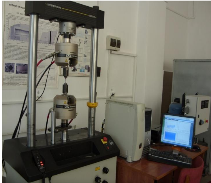
Fig. 3.7. Mașina de încercat Instron 8801 – solicitarea la oboseală
