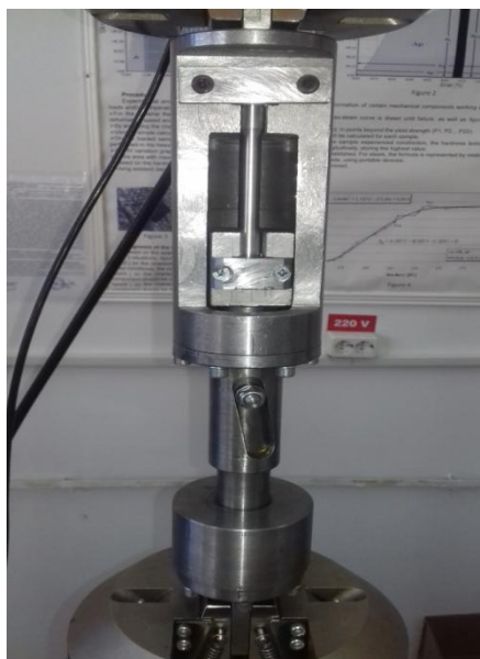
Fig. 5.2. Prinderea dispozitivului în bacurile dispozitivului mașinii de încercat
