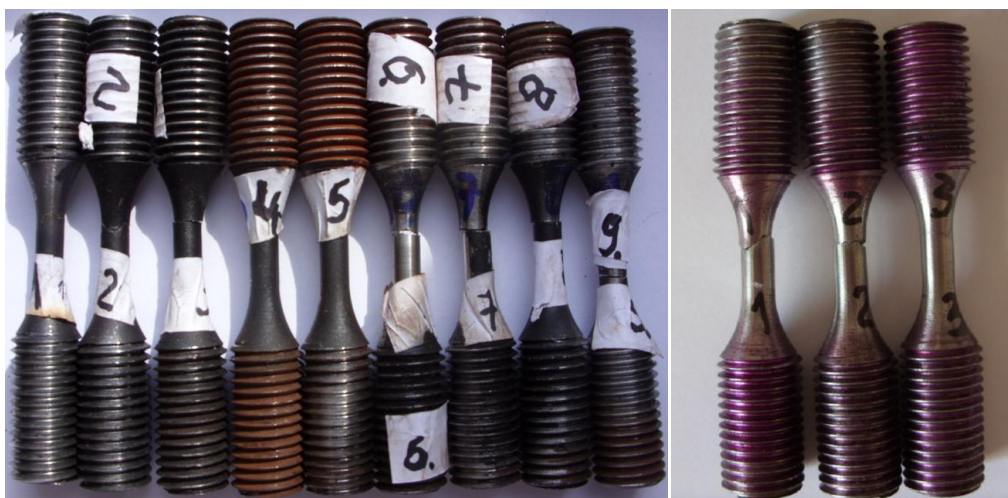
Fig. 2.7. Probele solicitate la oboseală din șinele '86 (a) și NOUA (b)
