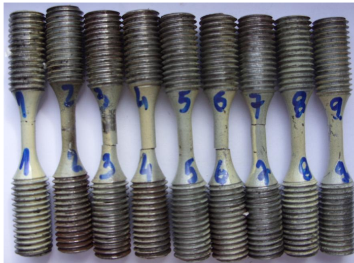
Fig. 2.6. Probele solicitate la oboseală din șina '85
