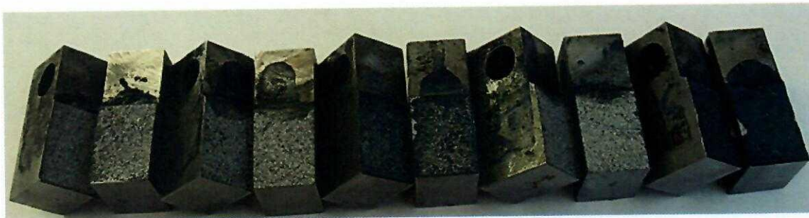
Fig. 4.17. Probe rupte prin încercarea K_{Ic} din șina '85
