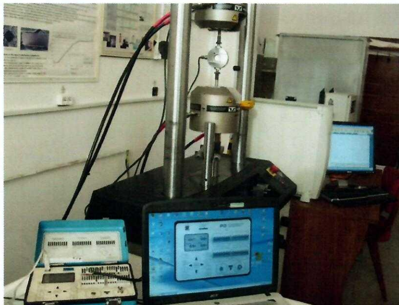
Fig. 1.11. Încercarea la tracțiune și achiziționarea semnalului de la mărcile tensometrice
