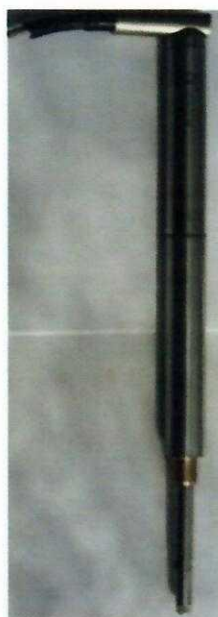
Fig. 2.10. Traductor inductiv de tip Hottinger, cu deplasarea maximă de 50 mm; b) modul de legare în punte pentru traductorul inductiv de tip Hottinger, cu deplasarea maximă de 50 mm
