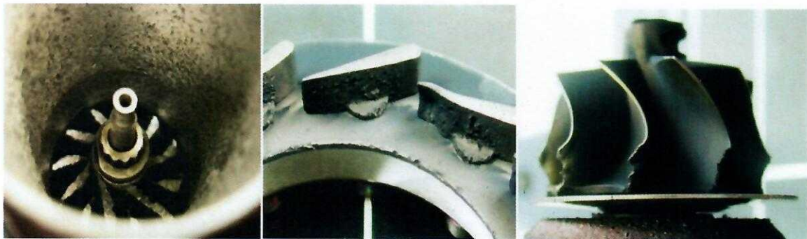
Fig. 8.26. Compresor deteriorat Fig. 8.27. Vane deteriorate. Fig. 8.28. Turbină deteriorată.
