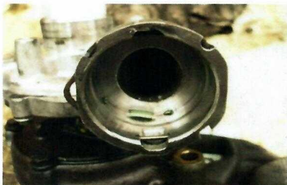
Fig. 8.18. Garnitură cuplajului Henn deteriorată
