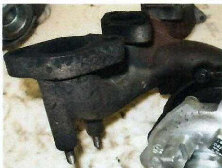
Fig. 8.49. Neetanșeitare la nivelul galeriei de evacuare
