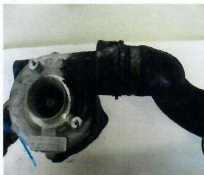
Fig. 8.39. Furtun presiune deteriorat
