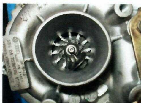
Fig. 8.21. Obiect străin deteriorează rotorul
