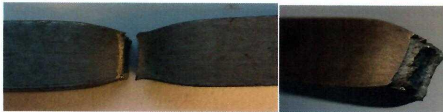
Fig. 6.3. Modul de rupere la tracțiune.
