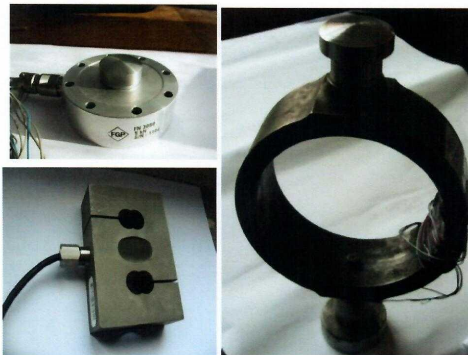
Fig. 1.10. Celule de forță – 5 kN, 20 kN, 50 kN
