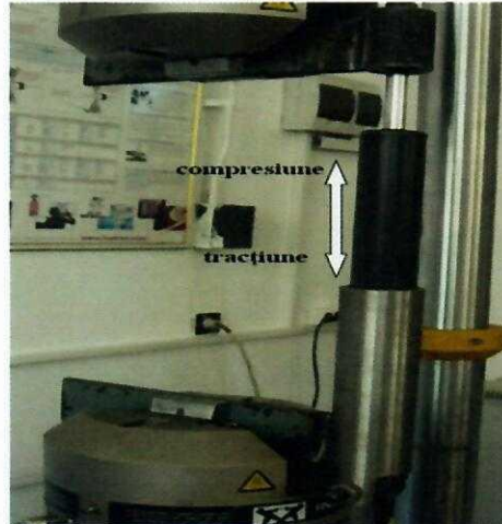
Fig. 7.19. Așezarea amortizorului în dispozitiv și prinderea pe mașina de încercat
