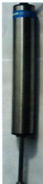
Fig. 2.9. a) Traductor rezistiv de tip Vishay, cu deplasarea maximă de 100 mm; b) raportul de calibrare pentru traductorul rezistiv de tip Vishay, cu deplasarea maximă de 100 mm
