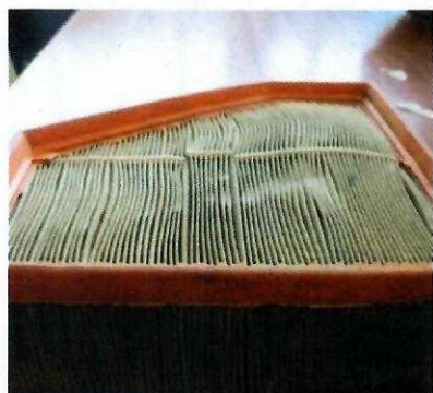
Fig. 8.42. Filtru de aer cu nervuri defecte
