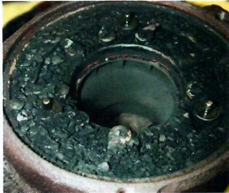
Fig. 8.30. Depozite de funingine pe geometria variabilă
