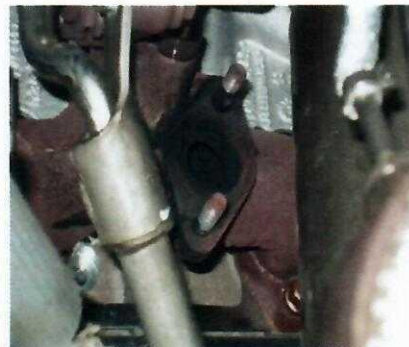
Fig. 8.50. Tubulatură EGR desprinsă
