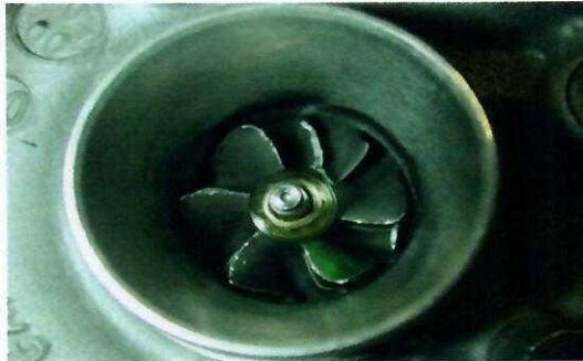
Fig. 8.48. Contaminare cu obiecte străine.
