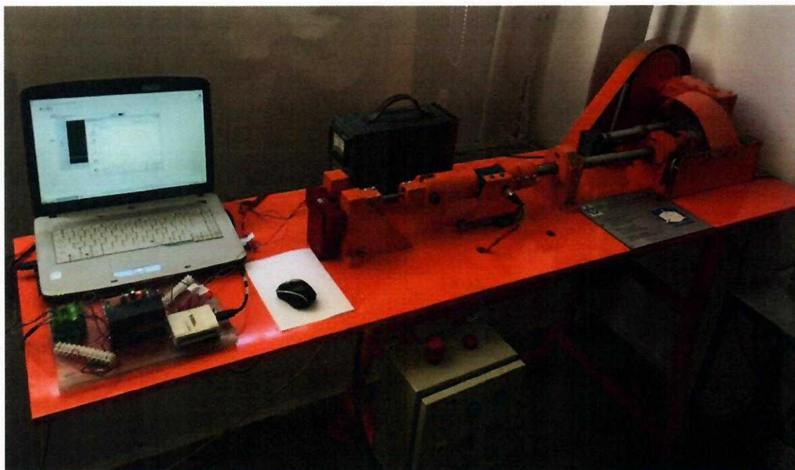
Fig. 3.19. Standul de tracțiune-răsucire cu traductoarele: cuplu, unghi, forță și deplasare
