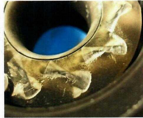
Fig. 8.31. Depozite de aditivi pe platoul vanelor
