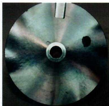
Fig. 8.43 Rotor compresor deteriorat prin supraturare – sarcina intră în contact
