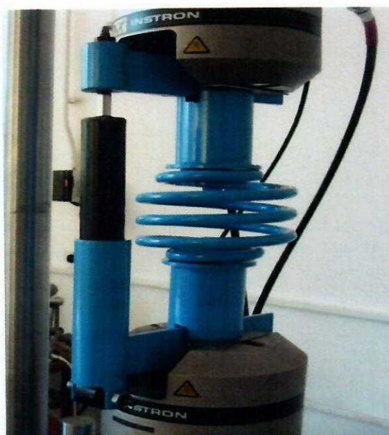
Fig. 7.34. Modul de prindere și solicitare a suspensiei spate
