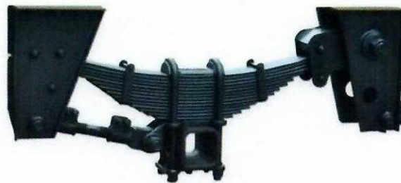
Fig. 7.2. Suspensia cu arcuri în foi dispuse longitudinal
