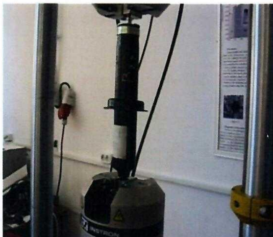
Fig. 7.6. Modul de prindere și solicitare a amortizorului față
