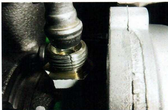
Fig. 8.15. Racord alimentare ulei crăpat
