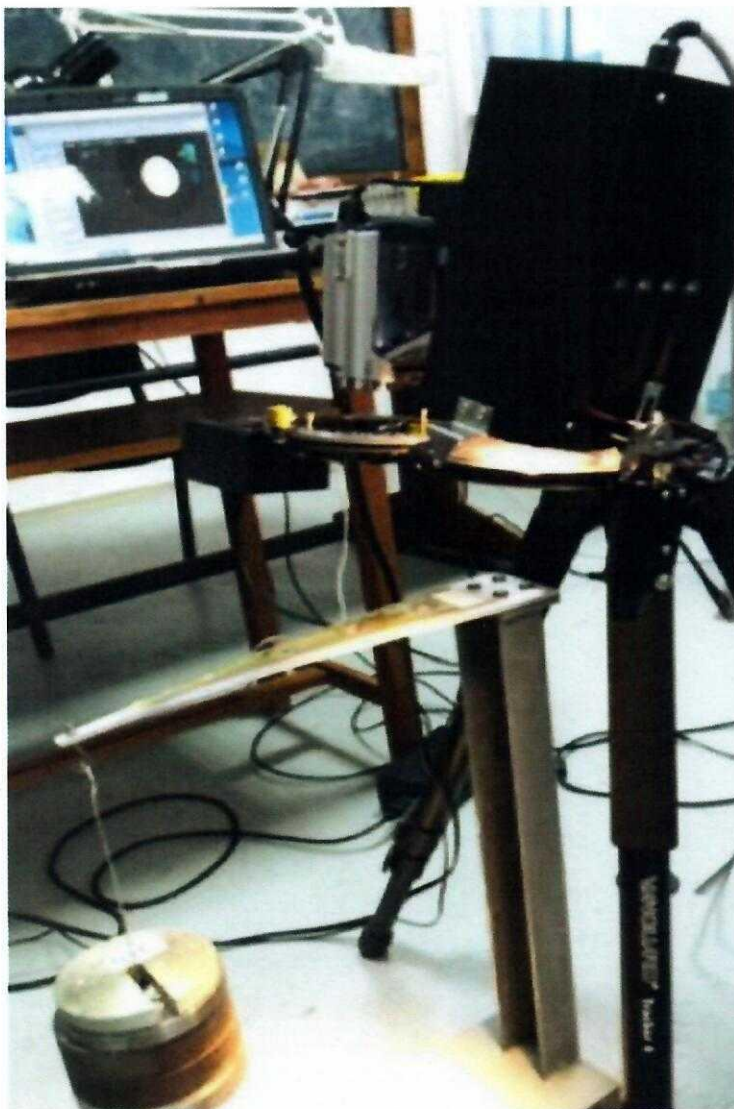
Fig. 5.13. Dispozitivul utilizat la încercări ce conține o bară de egală rezistență cu concentratori
