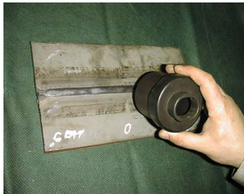
Fig. 1.13. Examinarea cu lupa a unei cusături sudate.
