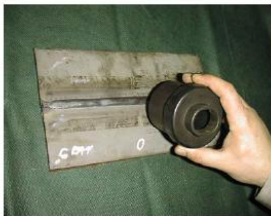
Fig. 1.13. Examinarea cu lupa a unei cusături sudate.
