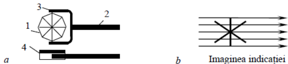
Fig. 1.19. Verificarea magnetizării: a - indicator de flux magnetic, 1 - segmente din oțel carbon brazate (8 buc.); 2 - mâner din material nemagnetic; 3 - articulații; 4 - suprafață de observare (0,20...0,25 mm) din cupru sau alamă; b - indicație caracteristică.
