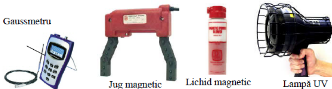
Fig. 1.20. Componente uzuale ale unui post de lucru cu pulberi magnetice.
