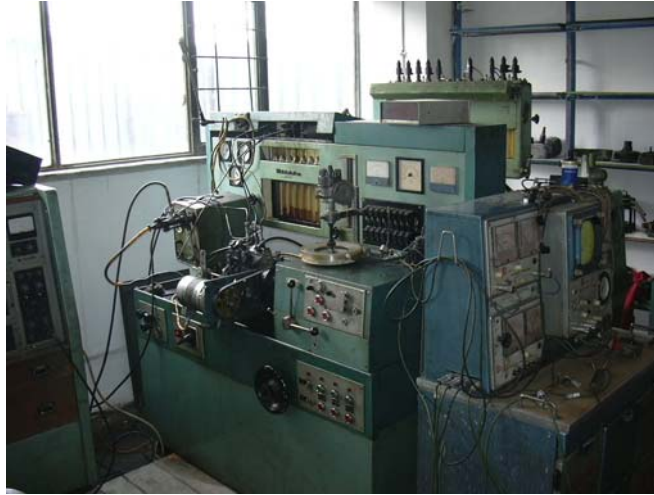
Stand pentru testarea echipamentelor de injectie
