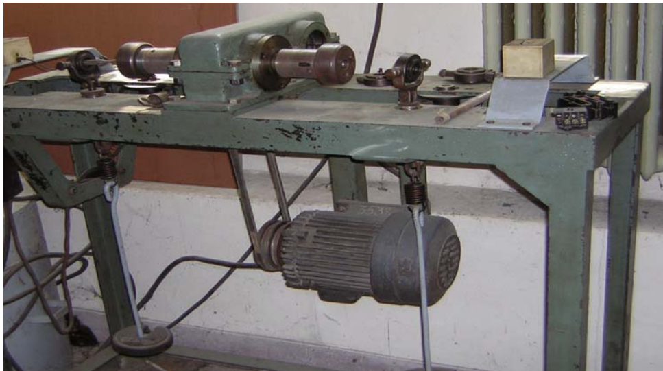
Masina de incercat la incovoiere rotativa, cu 4 posturi de lucru
