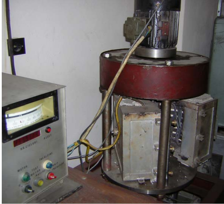
Masina de incercat la oboseala prin incovoiere rotativa, avand cuptor de incalzire pentru determinari la cald
