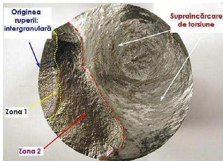
Fig. 4 Suprafața tipică de rupere prin oboseală
