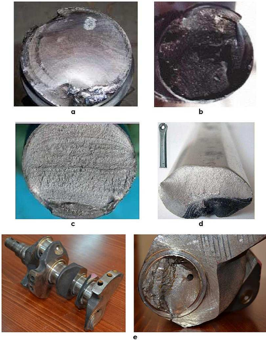
Fig. 6 Exemple de rupere prin oboseală: a – arbore, b – ax de turbină, c – șurub, d – bielă, e – arbore cotit
