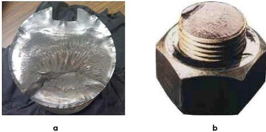
Fig. 2 Ruperea prin oboseală în zona concentratorilor de tensiuni: a – canal de pană, b – filet
