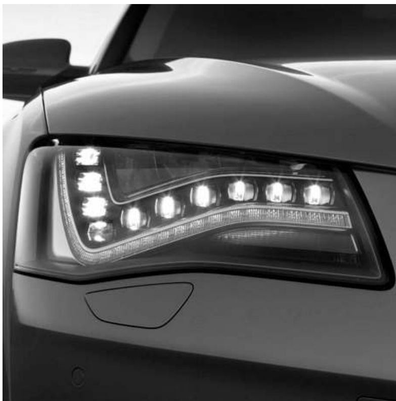
Fig.10.5.Far Audi A8 cu poziție , fază scurtă și fază lungă cu leduri
