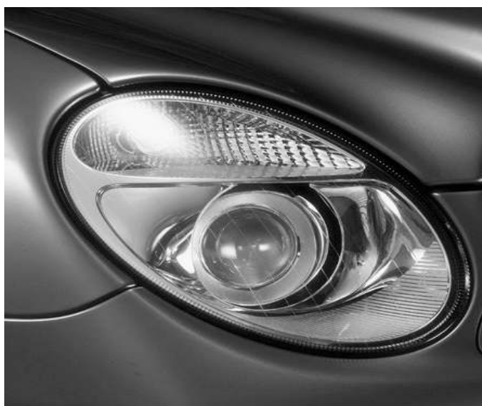
Fig.10.9.Far adaptiv cu lupă motorizată la Mercedes
