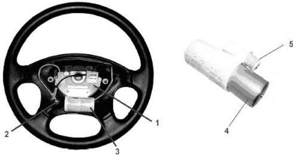
Fig.9.28. 1-calculator autonom, 2-martor defect, 3-ansamblu de pile, 4-pilă principală, 5-pilă secundară.
