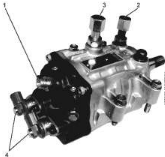
Fig.5.33;1 Ieșire carburant catre rampă, 2 Intrare carburant joasă presiune. 3 Retur rezervor.
