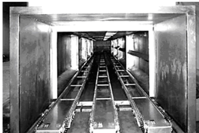
Fig. 2.27. Tunel de congelare cu trei căi de rulare, antrenare prin lanț
